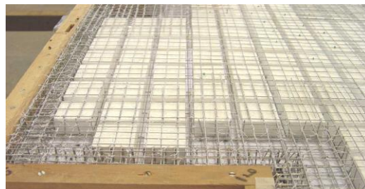
شکل ۱۲- اجرای دال در آزمایشگاه در مقیاس کوچک شده
